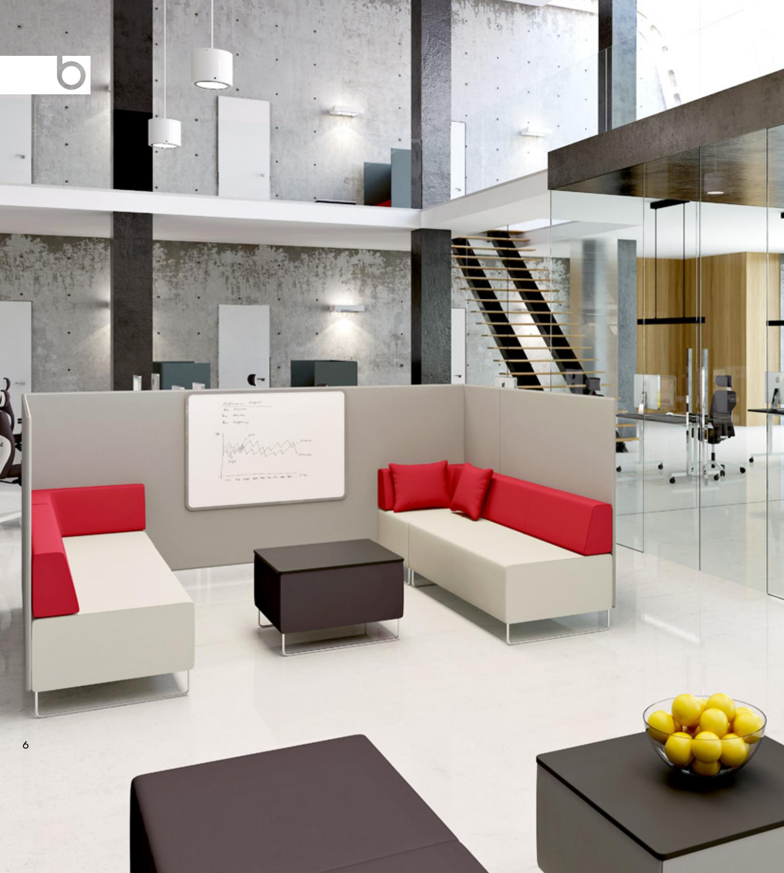
Ścianki Quadry wypełnione są bawełnianą strukturą włóknistą pasywnie akustyczną oraz wykończone tkaniną lub siatką 3D\_Harlequin. Badania przeprowadzone w katedrze Mechaniki i Vibroakustyki AGH w Krakowie, dowodzą, iż zastosowanie tych materiałów powoduje spadek głośności dźwięków, dochodzących z zewnątrz i wychodzących na zewnątrz, o połowę.
